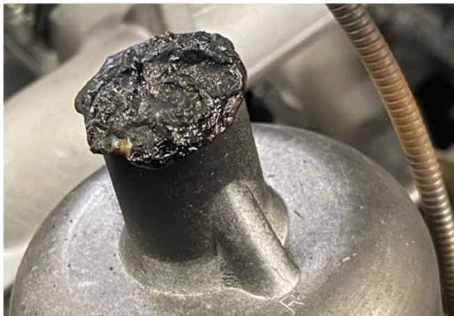
SU damper top looking a bit melty...
